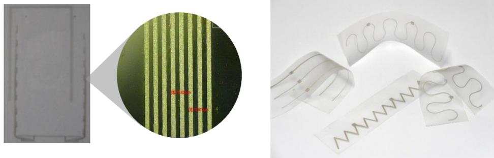
银粉的精细特性可对应高度精确的图案打印，其光滑的形状特征，可灵活的对应各种图案打印要求。
